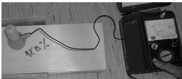
Slika 1: Merjenje vlage v lesu z električnim vlagomerom.
